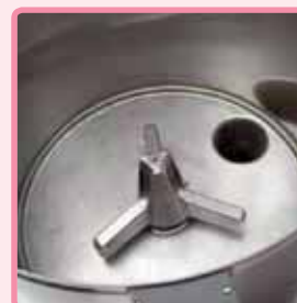
Scarico dell'acqua residua
