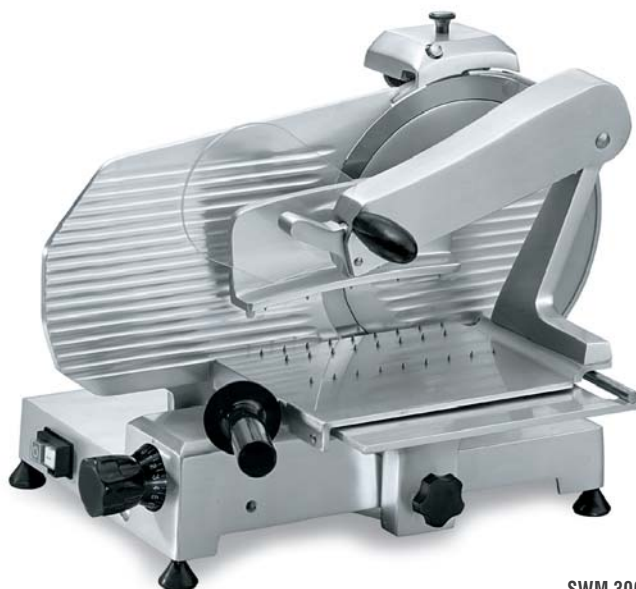
• Fusione in lega di alluminio anodizzato. • Ampio spazio tra motore e lama per un'agevole pulizia. • Motore ventilato. • Lama forgiata e temprata a forte spessore. • Perni scorrimento lappati. • Viteria e parafratta in acciaio inox. • Robusto supporto vela. • Affilatoio incorporato in fusione con doppio smeriglio di serie. • Dimensioni compatte ma con grande capacità di taglio. • Versione CE Professionale con sblocco su carro.
